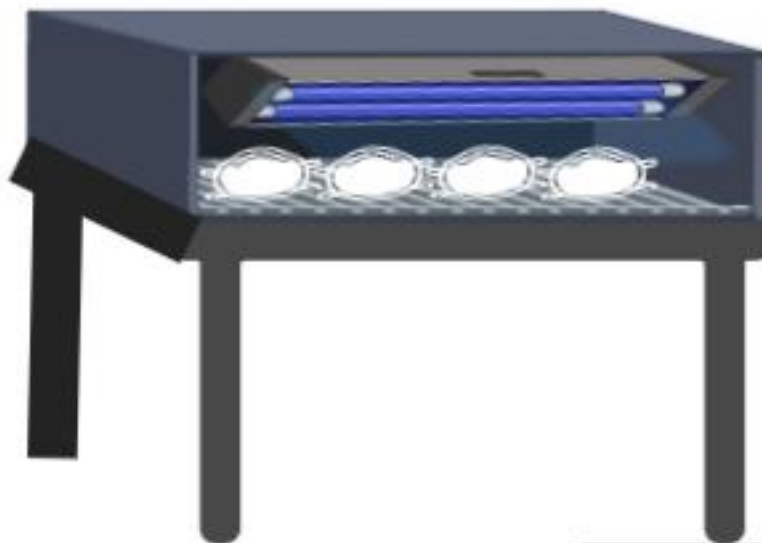
Figura N°2. Esquematización de prototipo de diseño de desinfección de mascarillas N°95 mediante una mesa y una caja adaptadas para disminuir la distancia entre la fuente emisora de luz UV y la superficie de las mascarillas, este diseño implica que se necesita rotar manualmente las mismas después de un determinado tiempo para permitir que ambas caras o superficies reciban la luz y se desinfecten. Adaptación gráfica desde modelo presentado por Hamzavi et al, 2020.
